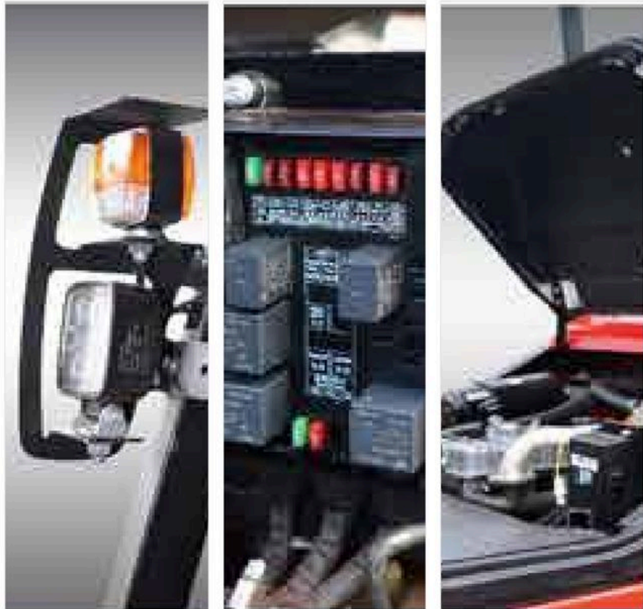
■ Светодиодные фары: экономичны, служат долго, без обслуживания ■ Модульный электрошкаф с высокой степенью защиты ■ Капот открывается широко — удобный доступ к двигателю
