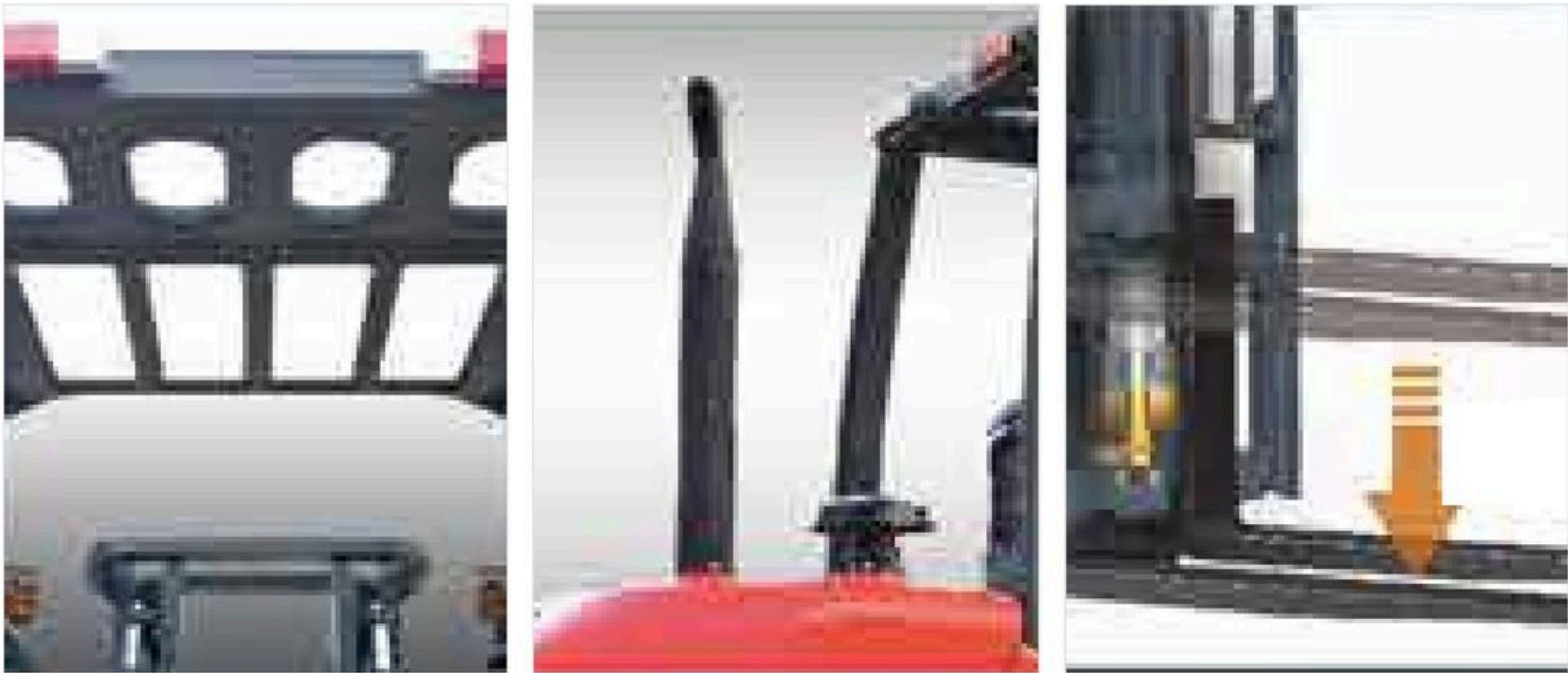
■ Защитная крыша ■ Высокий выхлоп ■ Демпфер опускания мачты
